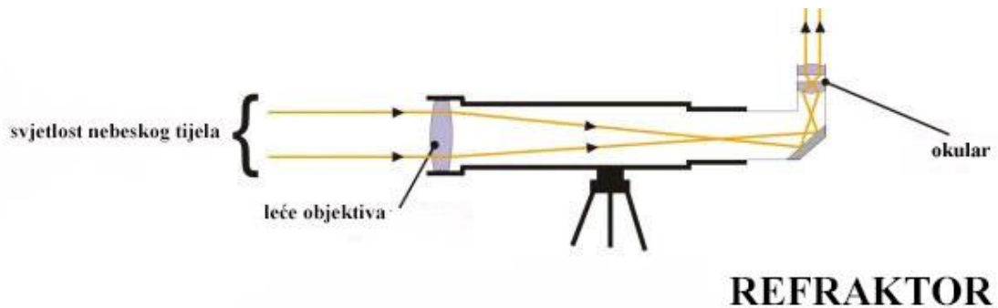
Slika 1 Princip rada refraktor teleskopa izvor: http://liverpoolas.org
