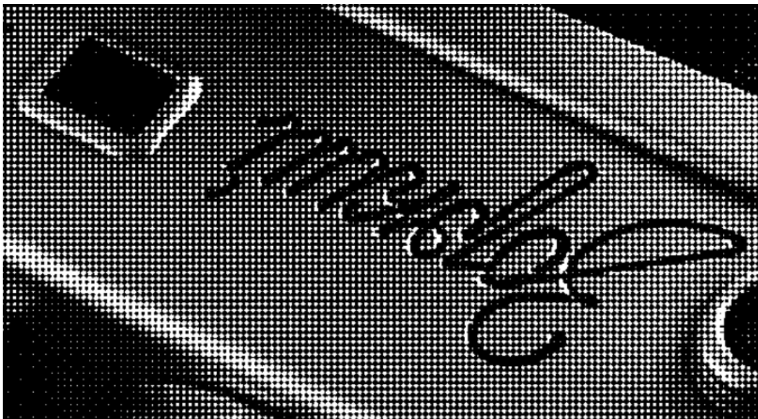
Slika 17. Rastrirana fotografija, spremna za ispis na film
