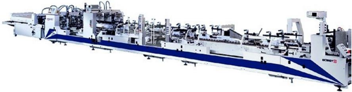
Slika 15. Ljepilica s više točaka ( http://www.spp.pl/ )
