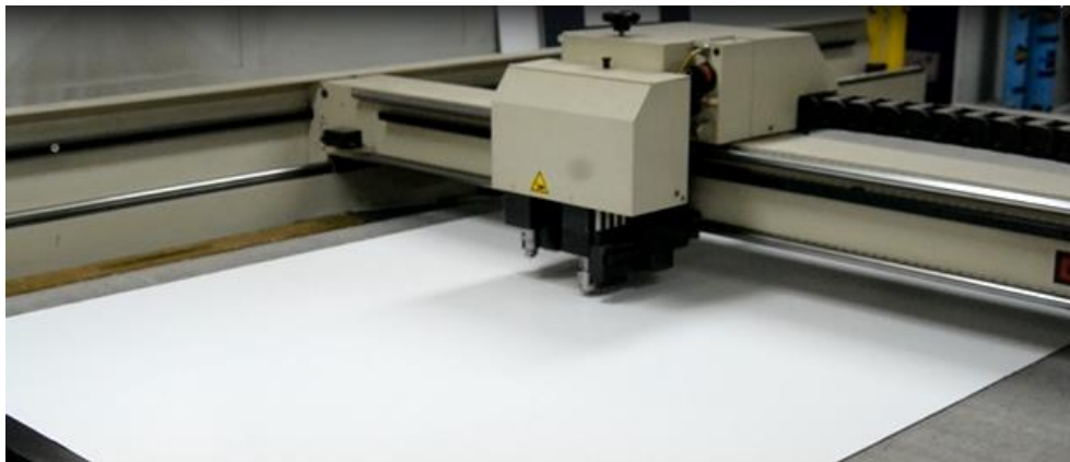
Slika 18. Plotter – cutter za izradu uzoraka ambalaže
