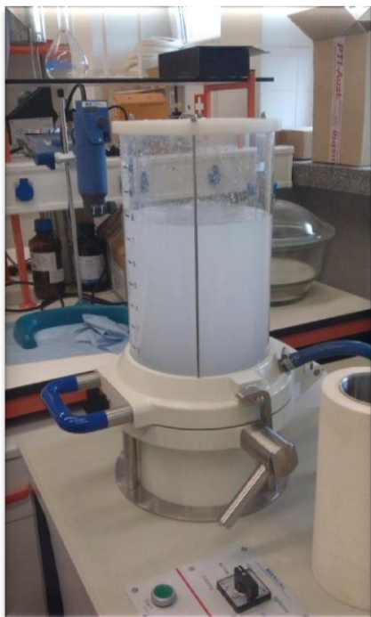
Slika 15. Uređaj za formiranje laboratorijskih listova PTI
