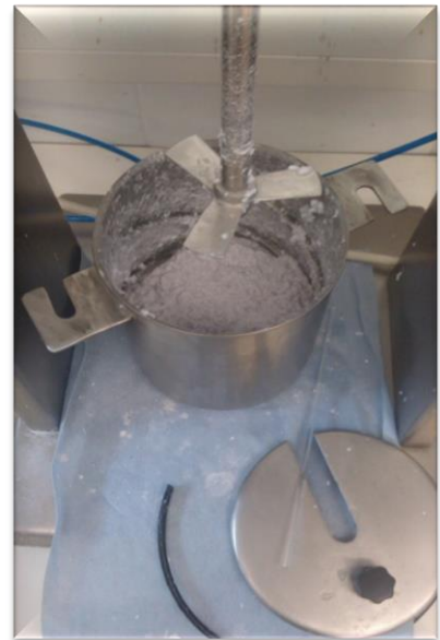
Slika 9. Dezintegracija (razvlaknjivanje) otisaka
