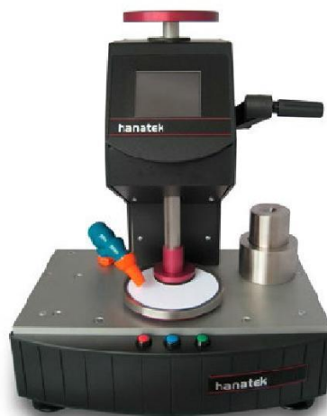
Slika 23. Uređaj Hanatek Rub and Abrasion Tester [24]
