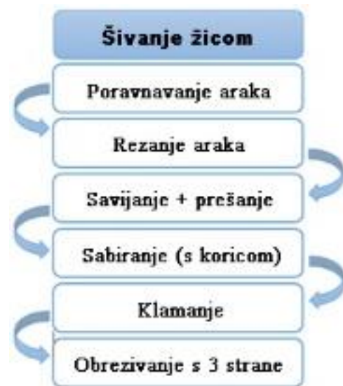
Slika 30. Tehnološka shema MUK - ručno šivanje žicom kroz hrbat (klamanje)
