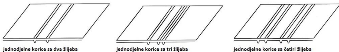
Slika 36. Žlijebovi na jednodijelnim kartonskim koricama
