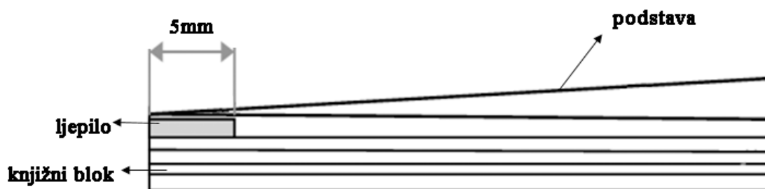
Slika 40. Lijepljenje podstave na knjižni blok
