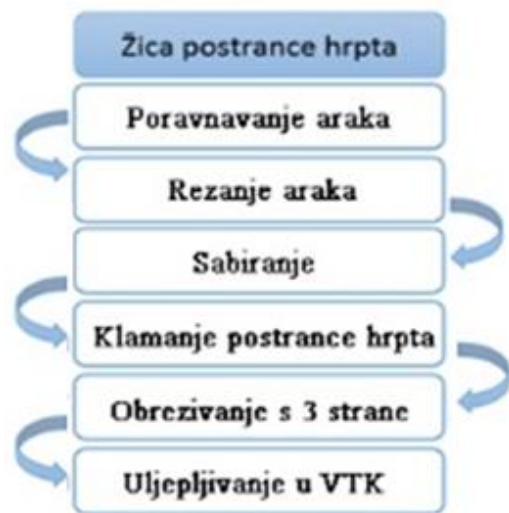
Slika 32. Tehnološka shema TUK - šivanje žicom postrance hrpta
