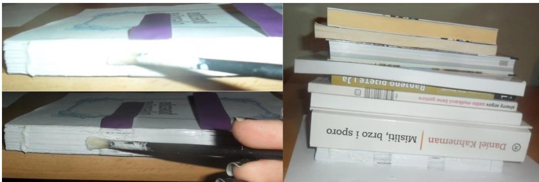
Slika 74. Nanošenje ljepila na gazu
