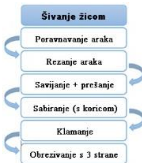
Slika 30. Tehnološka shema MUK - ručno šivanje žicom kroz hrbat (klamiranje)
