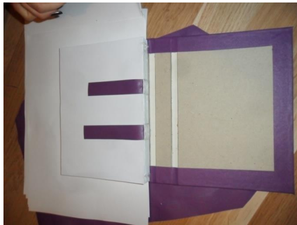
Slika 80. Naljepljivanje podstave na višedijelne tvrde korice
