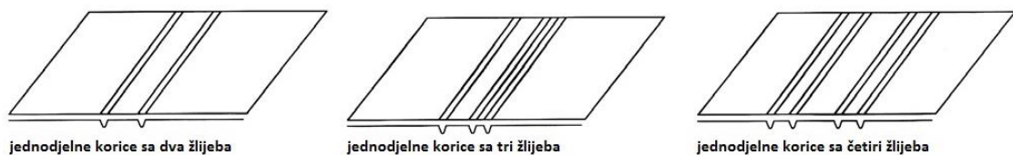
Slika 36. Žlijebovi na jednodijelnim kartonskim koricama
