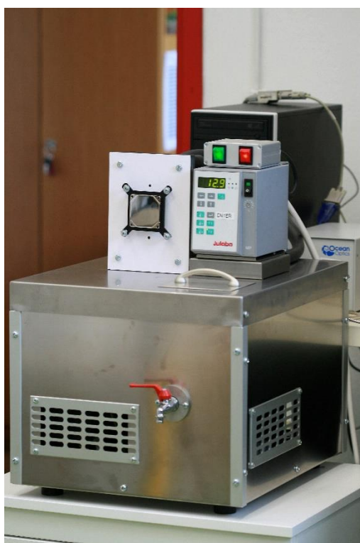
Slika 17. Termostatički cirkulator EK Water Blocks, EKWB d.o.o, Slovenija
