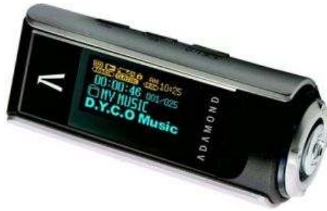
Slika 7. Pasivni OLED zaslon
