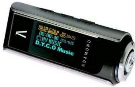
Slika 7. Pasivni OLED zaslon
