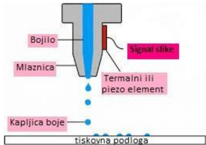
Slika 8. Princip rada diskontinuiranog inkjeta
