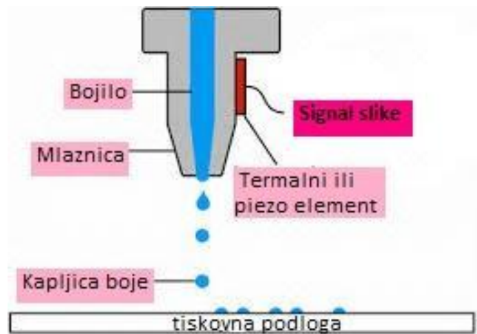
Slika 8. Princip rada diskontinuiranog inkjeta
