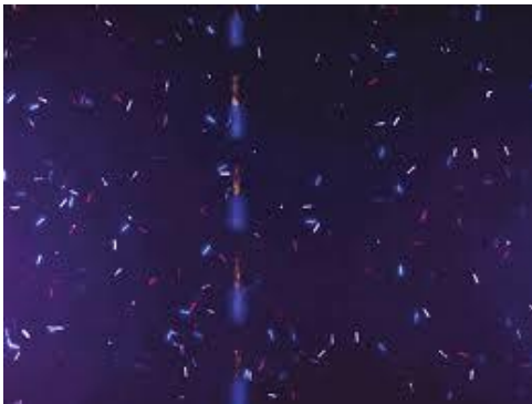
Slika 3.: Detalj arka papira za izradu novčanica pod UV-svjetlom (preuzeto s www.mup.hr )
