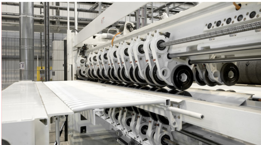
Slika 21. Uređaj za uzdužno rezanje slojeva ( http://www.bhs-asiapacific.com/?en-p-d-66.html )
