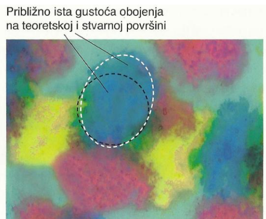
Slika 15. Prikaz smicanja okruglog rasterskog elementa na stvarnom višebojnom otisku
