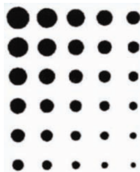
Slika 2. Različiti postoci RTV kod AM rastriranja
