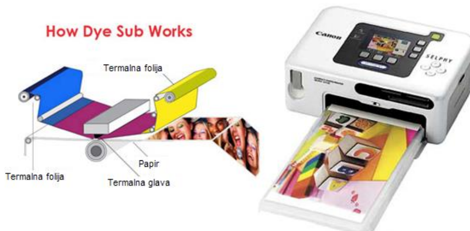
Slika 9: Princip rada kod sublimacijskog pisača
