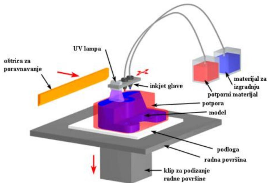
Slika 7.8 Princip 3DP PJ postupka
