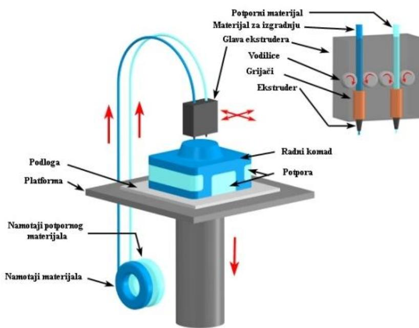
Slika 7.3 Princip FDM postupka
