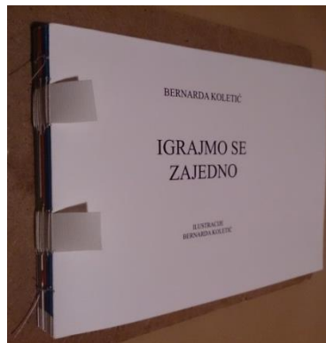
Slika 24. Prikaz knjižnog bloka šivanog koncem preko vezica
