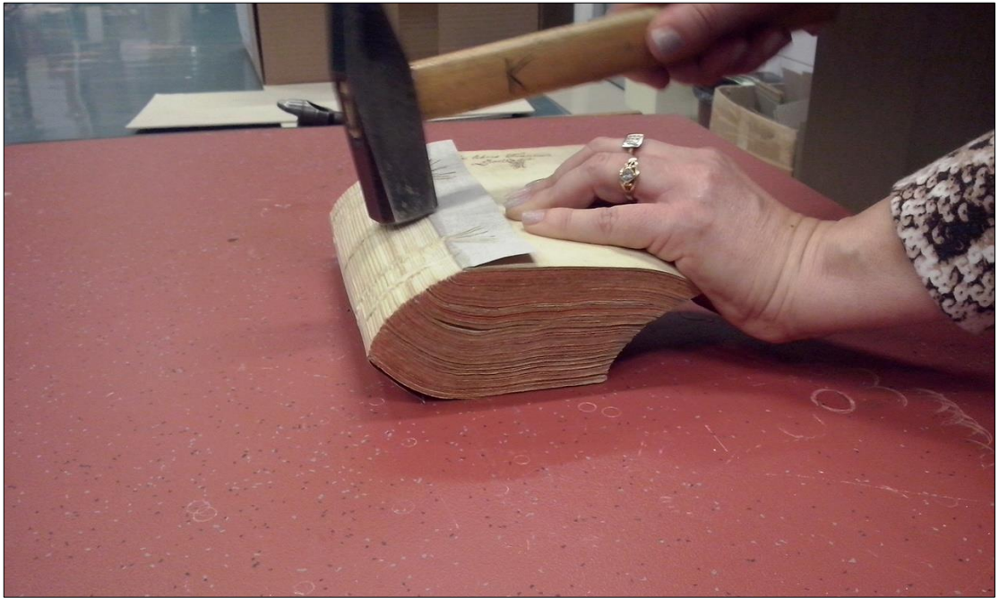
Slika 43. Ručno zaobljavanje hrpta knjižnog bloka
