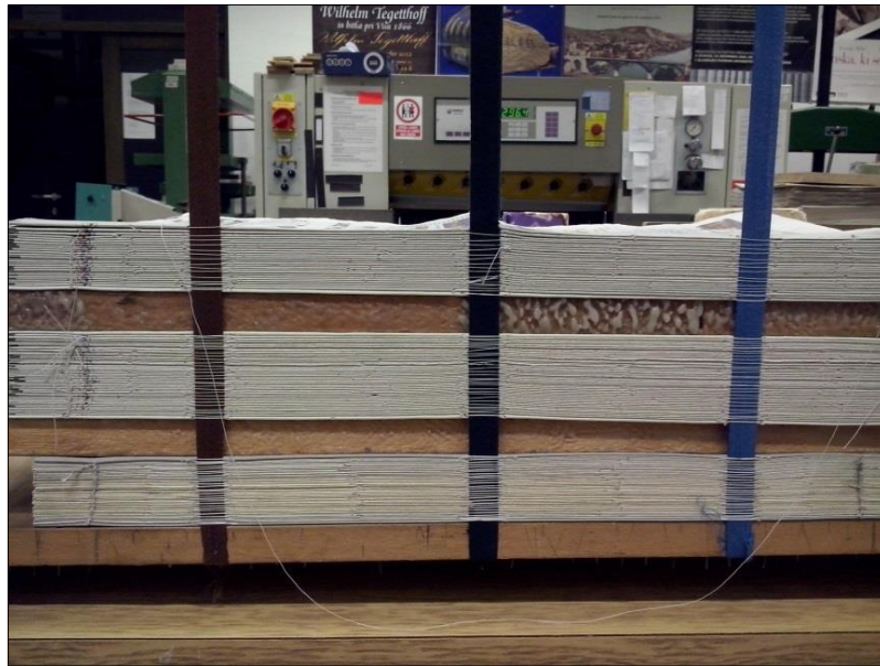
Slika 19. Ručno povezivanje knjižnih slogova uz pomoć platnenih traka; prešivanje platnenih vezica
