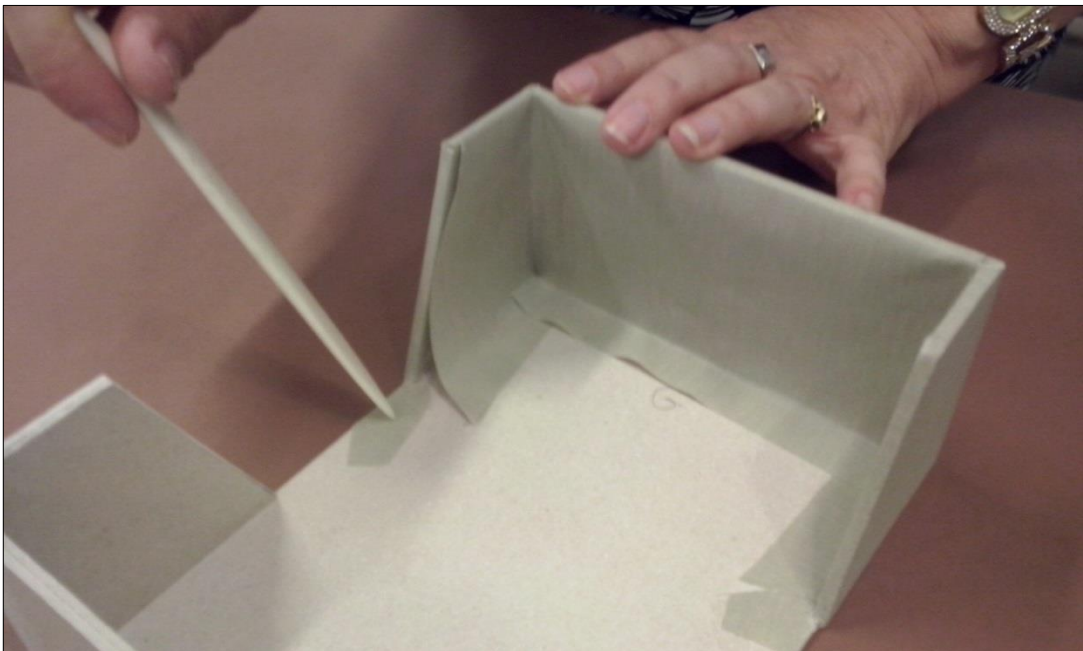
Slika 53. Presvlačenje donje kolijevke presvlakom od arhivskog platna
