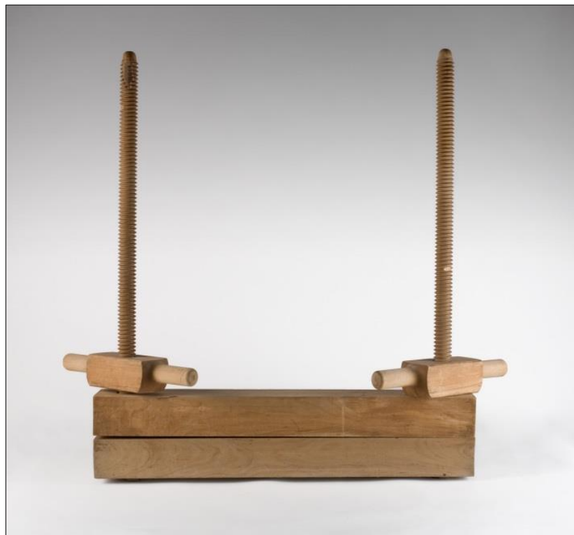
Slika 27. Ručna knjigoveška preša – www.crescat.hr
