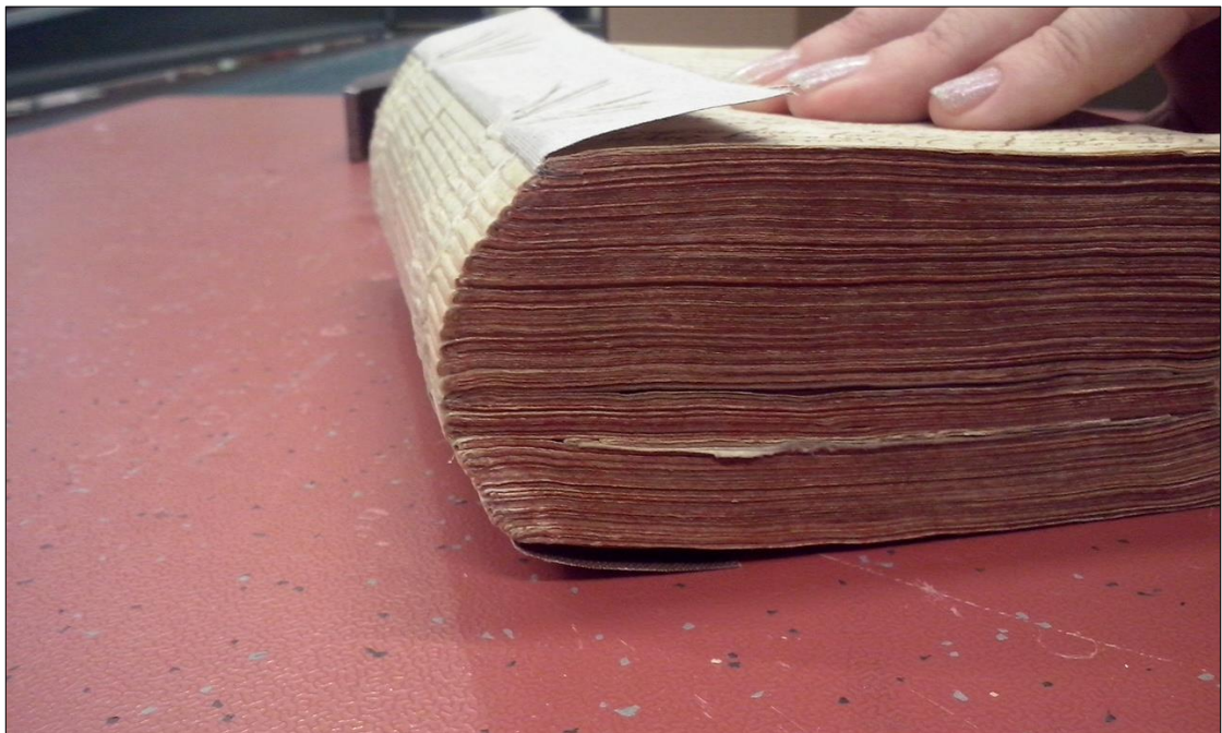
Slika 44. Zaobljeni hrbat knjižnog bloka
