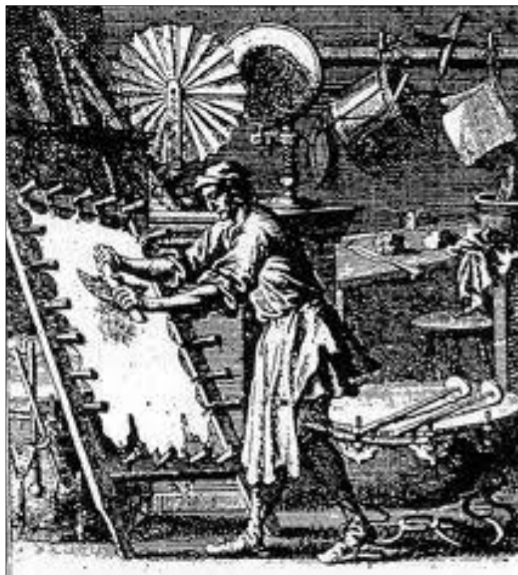
Slika 24. Okvir za napinjanje pergamenta u srednjem vijeku – www.adfontes.uzh.ch
