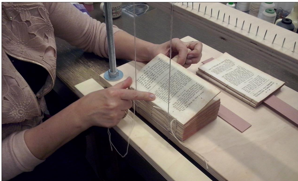
Slika 40. Šivanje na šivaljki, na dvije upiljene vezice
