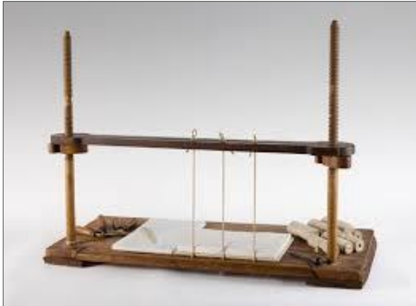
Slika 26. Šivaljka za šivanje knjiga – www.crescat.hr
