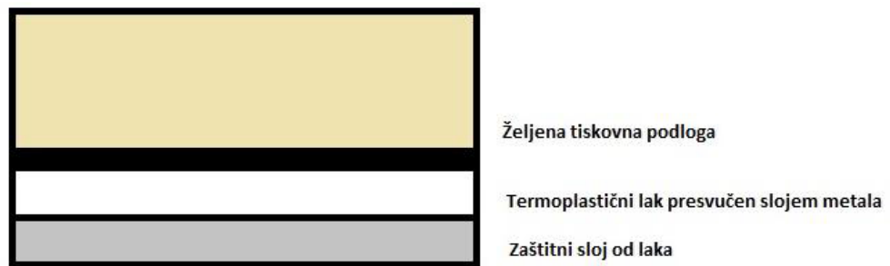
Slika 19. Prijenos na željenu tiskovnu podlogu [16]
