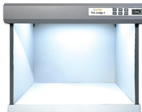
Slika 10: Kućica za vizualno ocjenjivanje boja pod različitim izvorima svjetla
