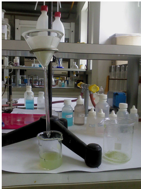
Slika 9: Filtracija nakon ekstrakcije
