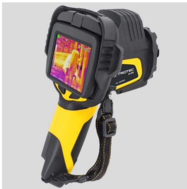
Slika 11 - Infracrvena kamera za mjerenje temperature
