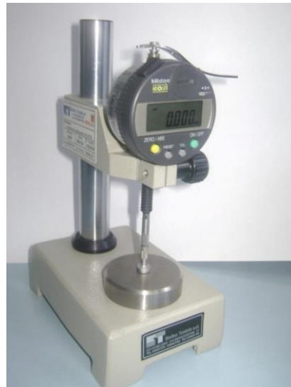
Slika 9. Mikrometar za mjerenje debljine papira
