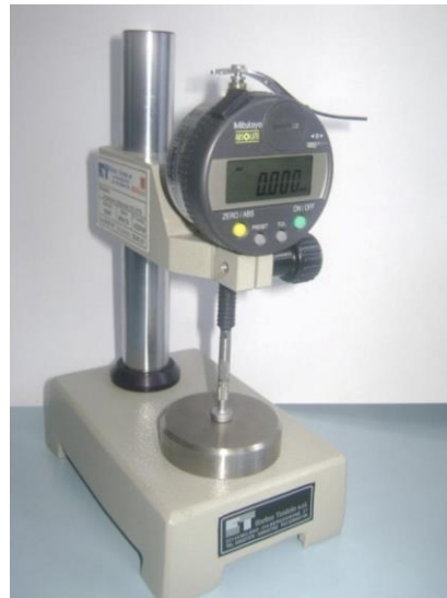
Slika 9. Mikrometar za mjerenje debljine papira
