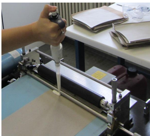
Slika 5. Doziranje premaza pipetom
