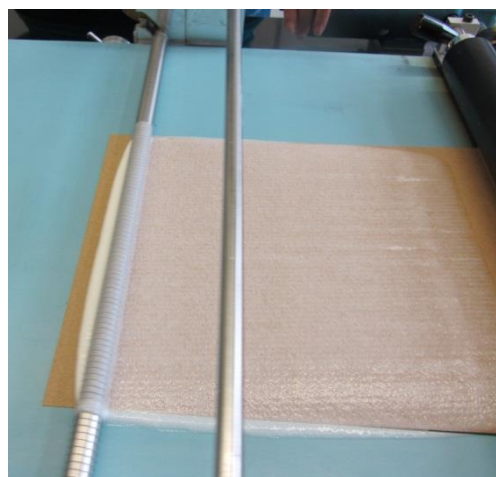
Slika 6. Premazivanje metalnim štapom
