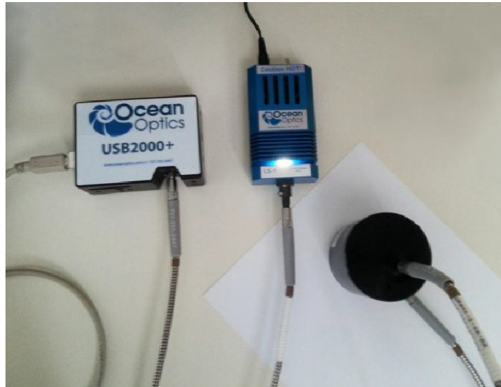
Slika 8. Mjerenje kolorimetrijskih promjena pomoću spektrofotometra Ocean OpticsUSB 2000+
