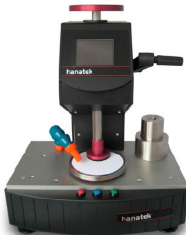
Slika 7. Uređaj Hanatek Rub and Abrasion Tester
