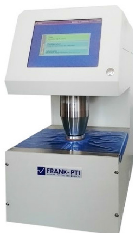
Slika 5. Uređaj PTI-Line Bekk
