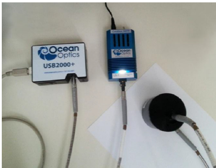
Slika 8. Mjerenje kolorimetrijskih promjena pomoću spektrofotometra Ocean OpticsUSB 2000+
