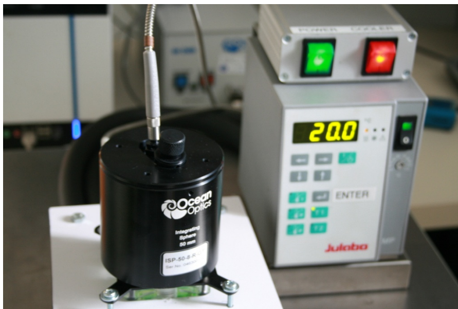
Slika 10. Mjerenje kolorimetrijskih promjena pomoću spektrofotometra Ocean Optics USB 2000+
