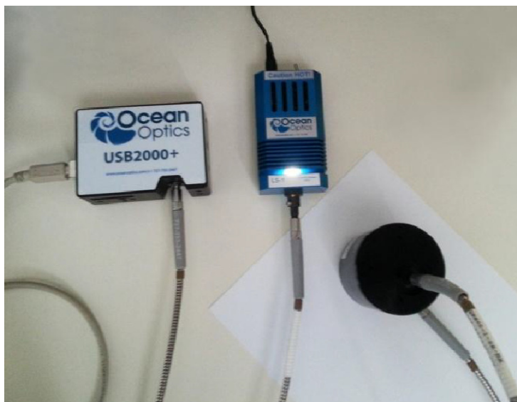
Slika 8. Mjerenje kolorimetrijskih promjena pomoću spektrofotometra Ocean OpticsUSB 2000+
