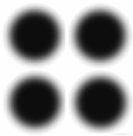
Slika 9 - Optički prirast rasterske vrijednosti uslijed bočnog raspršenja [5].
