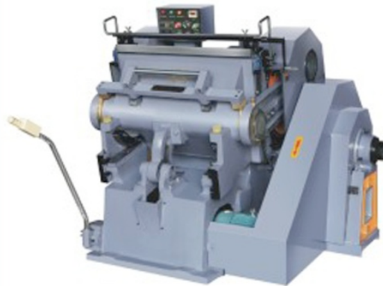
Slika 19 Zaklopna stanca formata B2; stroj ML 750 [2]
