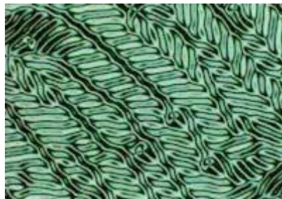
Slika 17. Mikroskopom uvećane molekule tekućeg kristala
