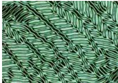
Slika 17. Mikroskopom uvećane molekule tekućeg kristala
