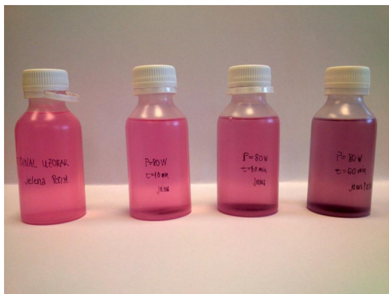
Slika 10. Usporedba originala i ultrazvučno ozračenih uzoraka snagom ultrazvuka od 80 W pri različitim vremenima trajanja ozračivanja
