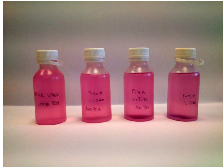
Slika 9. Usporedba originala i ultrazvučno ozračenih uzoraka snagom ultrazvuka od 30 W pri različitim vremenima trajanja ozračivanja
