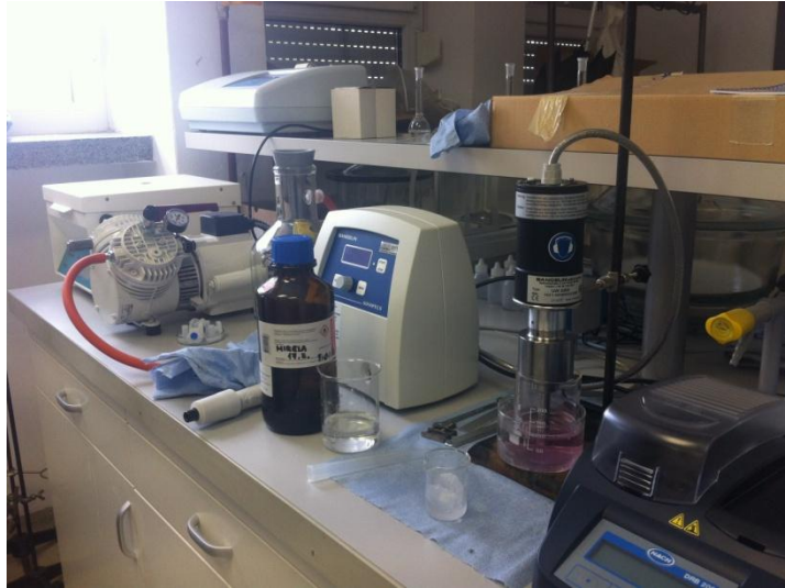
Slika 5. Ultrazvučni homogenizator Bandelin Sonoplus (HD 3100)
