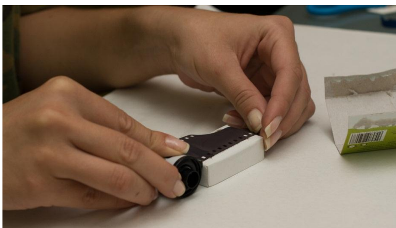
Slika 8. Mjerenje širine otvora preko broja rupica na filmu
