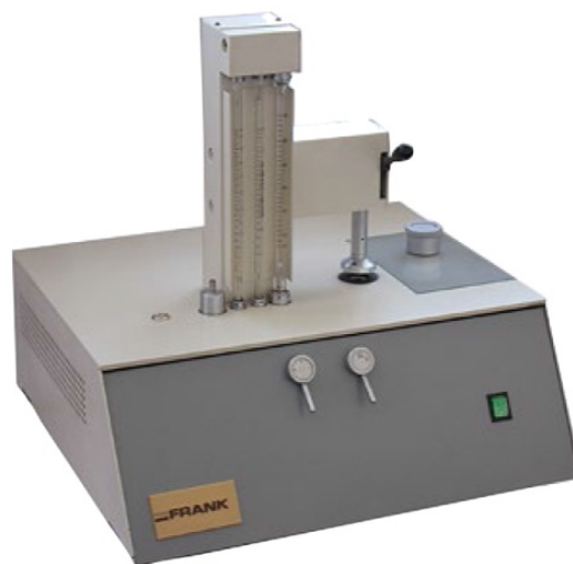
Slika 19. Uređaj za mjerenje propusnosti papira na zrak (Bendtsen metoda)
