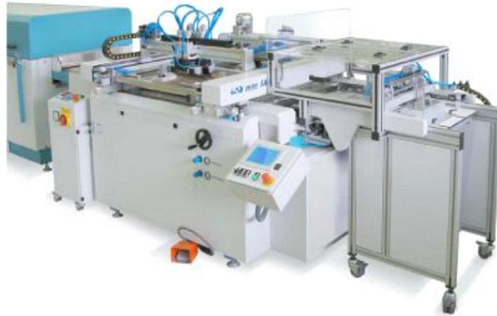
Slika 10: Potpuno automatski tiskarski stroj za sitotisak
