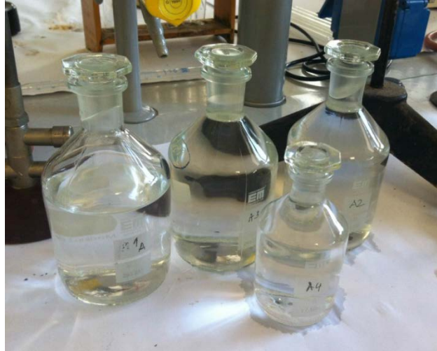
Slika 15: Boce po Winkleru
