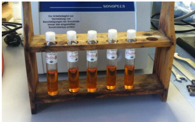
Slika 14: Pripremanje uzoraka za određivanje kemijske potrošnje kisika Hach metodom 8000
