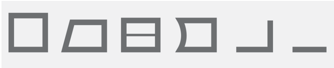
Slika 8. Presjeci metalnih okvira za propusni tisak
