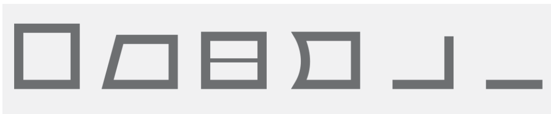
Slika 8. Presjeci metalnih okvira za propusni tisak
