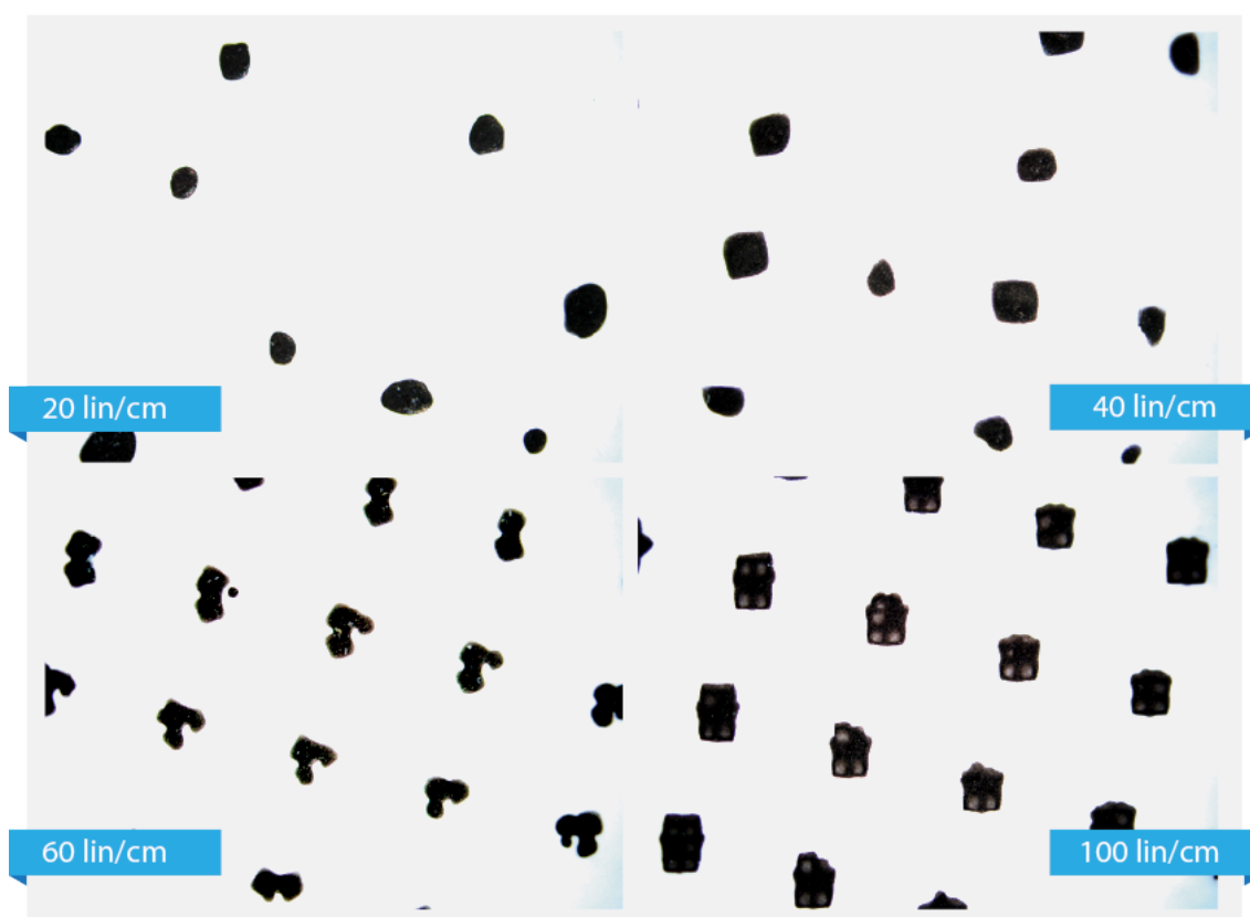
Slika 19. Mikroskopski prikaz polja niske RTV (polja 2 kontrolnog klina snimljena pod povećanjem od 50x)
