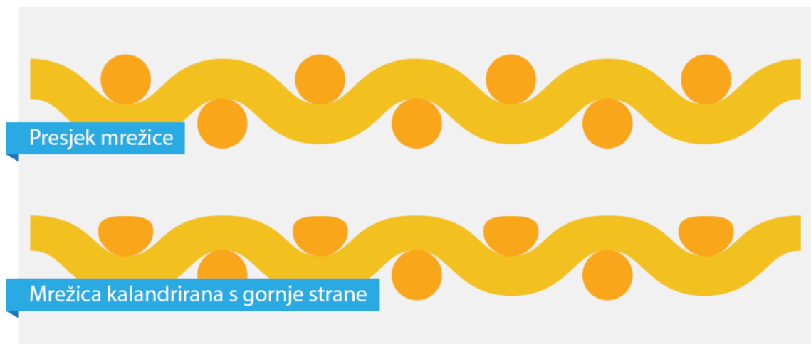
Slika 4. Presjek obične i kalandrirane mrežice
