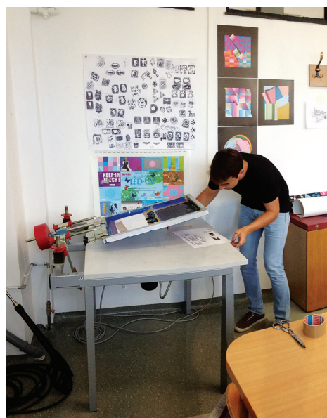
Slika 13. - Otiskivanje uzoraka za ravnim stolom
