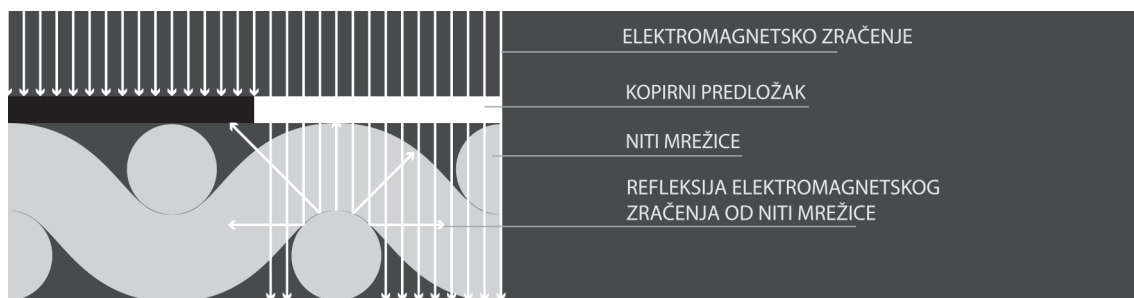
Slika 5. - Osvjetljavanje bijele sitotiskarske mrežice
