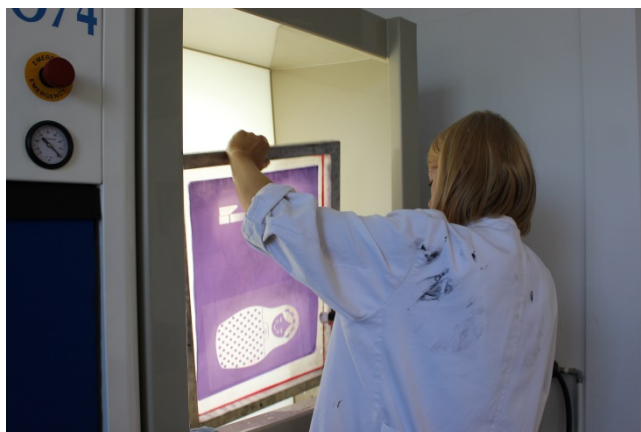
Slika 15. Proces ispiranja neosvjetljene emulzije sa sita
