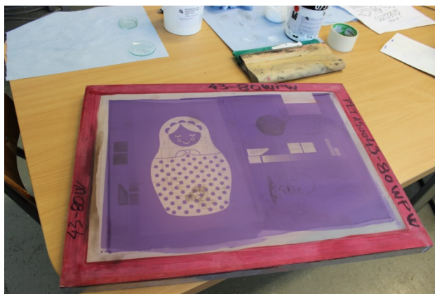
Slika 16. Gotova tiskovna forma za sitotisak
