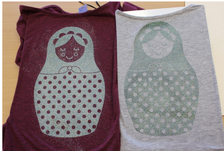
Slika 25. Rezultat otiska čestica s reflektirajućim efektom na tekstilu
