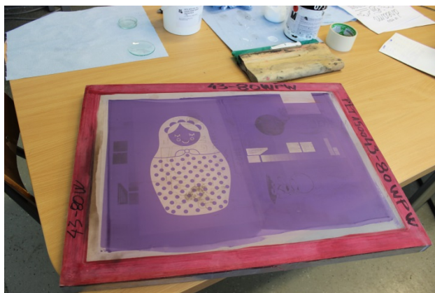
Slika 16. Gotova tiskovna forma za sitotisak
