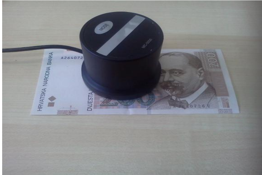
Slika 23. Detektor zaštitnih elemenata na dokumentima i vrijednosnicama
