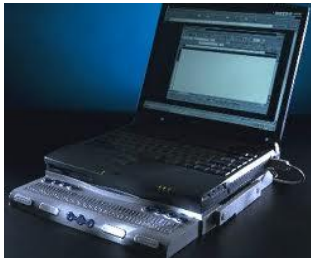
Slika 6. Računalo za slijepe osobe (izvor: www.hrvatskisavezsljepih.hr )
