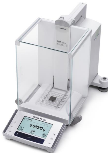
Slika 7. Analitička vaga Mettler Toledo XS205
