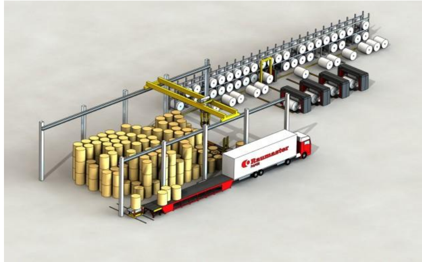
Slika 4. Shematski prikaz istovara papira i njegovog skladištenja
