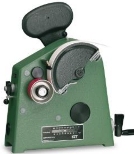
Slika 5. IGT uređaj tipa A2 [8] [materijali – vježbe - čupanje]
