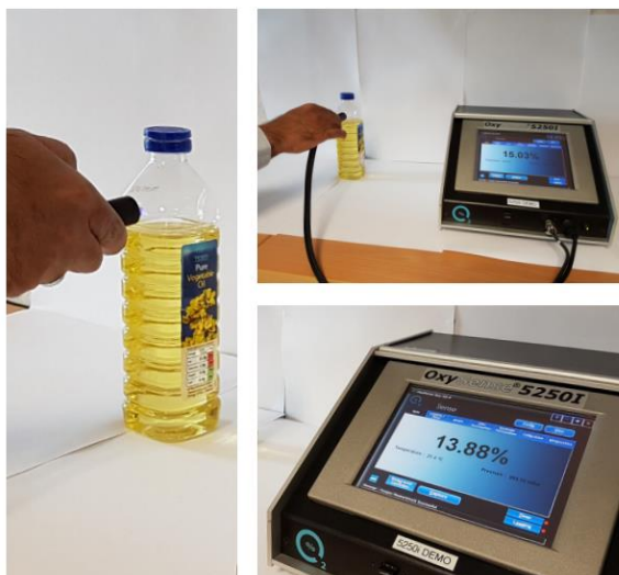
Slika 15. Uređaj za otkrivanje prisutnosti kisika unutar ambalaže [8]
