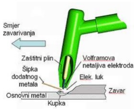
Slika 4. Zavarivanje s netaljivom elektrodom u zaštitnoj plinskoj atmosferi
