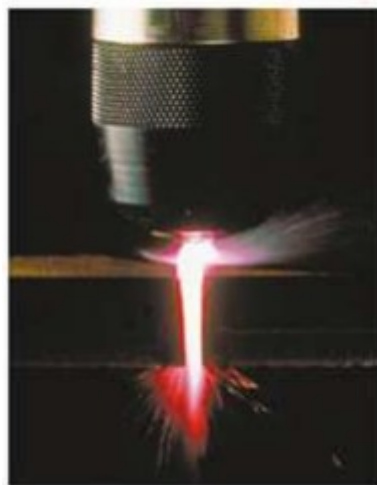
Slika 5. Zavarivanje plazmenim lukom
