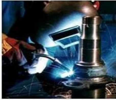
Slika 3. Zavarivanje s taljivom elektrodom u zaštitnoj plinskoj atmosferi
