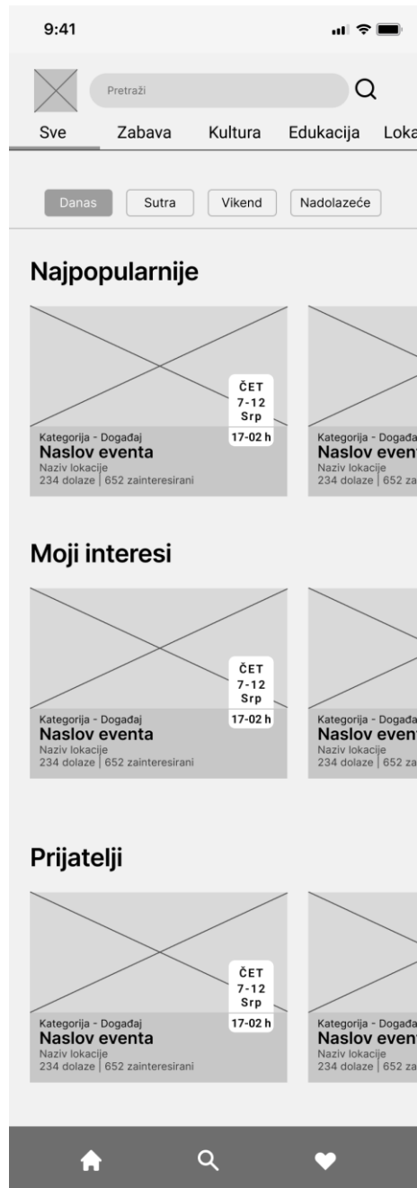
Slika 4. Primjer digitalnog srednje funkcionalnog žičanog modela ranih iteracija ekrana početne stranice i sistema filtriranja iz eksperimentalnog dijela unutar programa Figma
